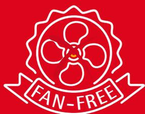
Il s'agit là d'une caractéristique commune à tous les régulateurs de tension IP21. Elle augmente énormément la fiabilité, car elle assure le refroidissement des composants magnétiques et des cartes électroniques sans avoir recours à des ventilateurs (système fan-free), éléments qui, avec d'éventuels filtres, doivent être périodiquement vérifiés, nettoyés et remplacés.
